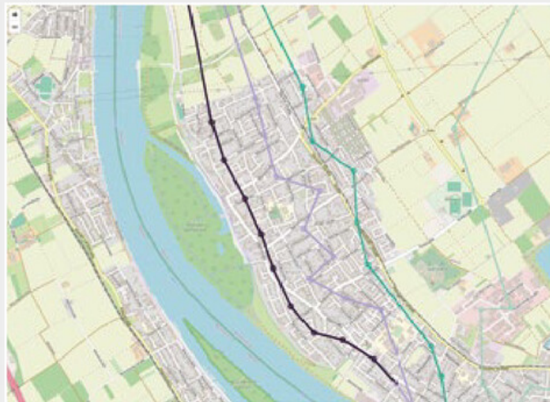
Bild 2. Verbraucher-Clustering zu Ortsnetzstationen (a), daraus abgeleitetes Mittelspannungsnetz (b)
